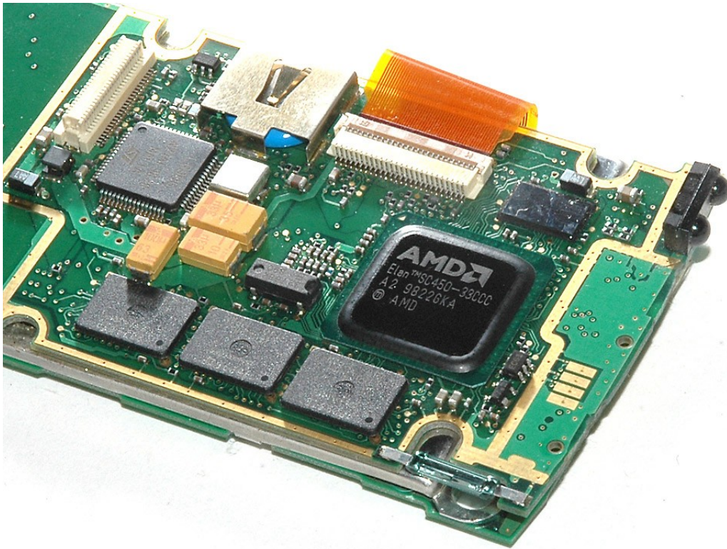
Slika 4: Sistem na čipu AMD Élan SC450 v Nokia 9000 komunikatorju
